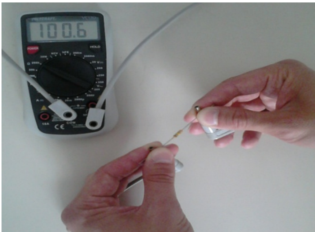
Слика 5.2. Неправилно мјерење отпорности отпорника
