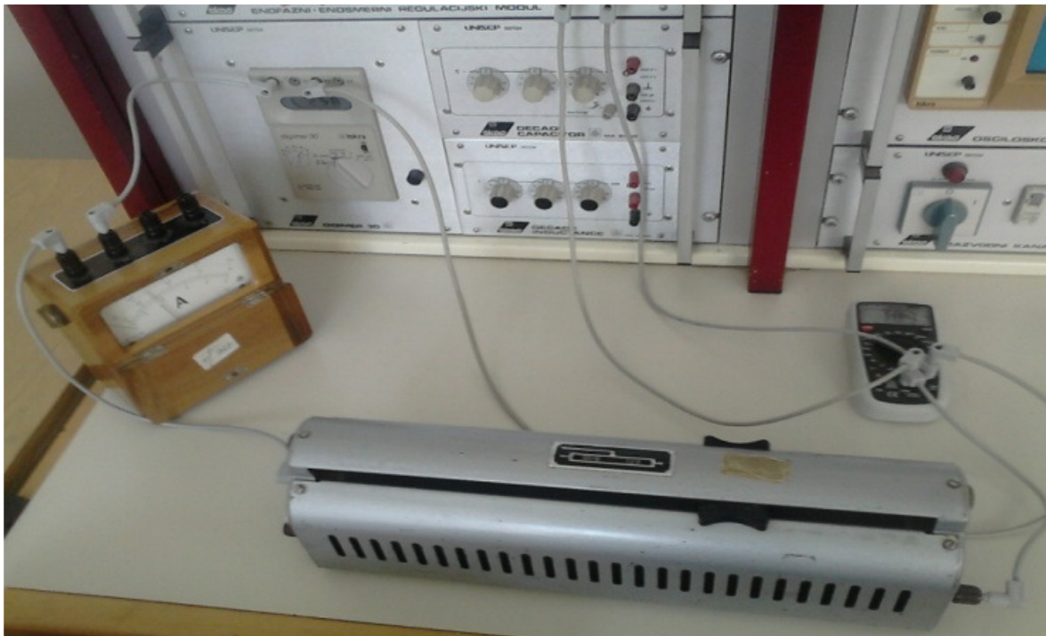
Слика 5.6. Спојена електрична шема са слике 5.5.
