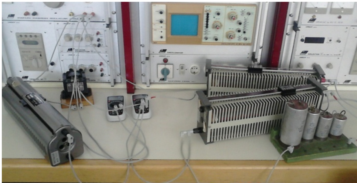
Слика 5.21. Максвел – Винов мост у лабораторији за електрична мјерења
