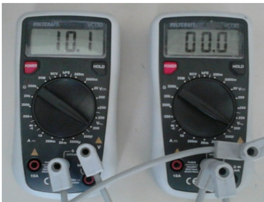
Слика 5.20. Вриједност напона на мултиметру када је мост у равнотежи
