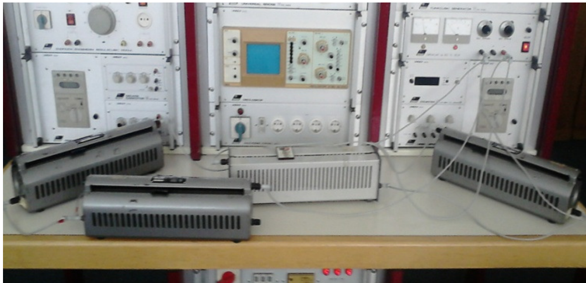
Слика 5.17. Витстонов мост у лабораторији за електрична мјерења
